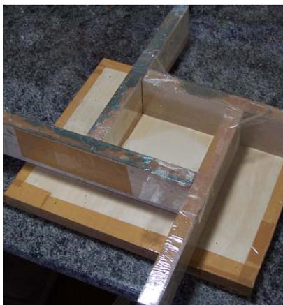
**Figura 8.** Montagem da contenção de madeira que recebe a parafina e a amostra.
