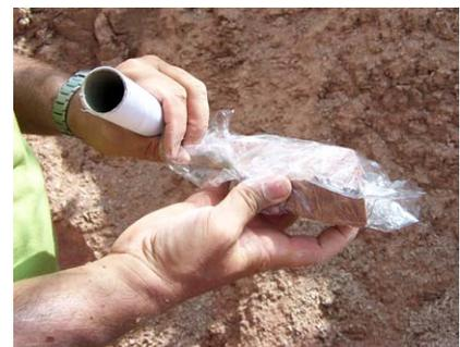
**Figura 6.** Cobertura da amostra com filme transparente de PVC para evitar o ressecamento da amostra e dano aos organismos preservados.
