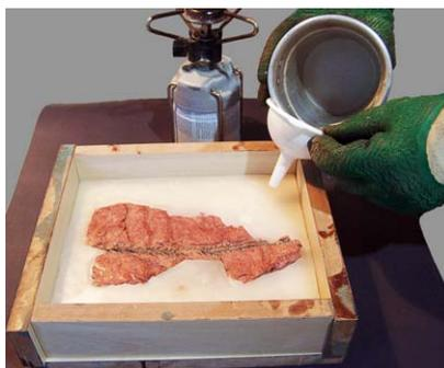
**Figura 10.** Colocação da amostra sobre a base de parafina e preenchimento dos espaços laterais, evitando recobrir a face superior da mostra e o exemplar fóssil.
