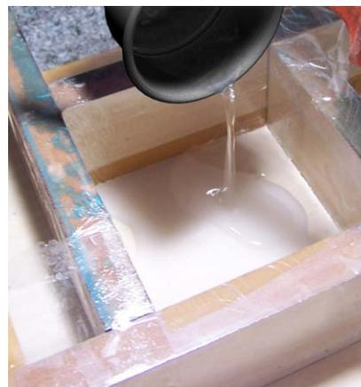
**Figura 9.** Elaboração da base de parafina sobre a qual a amostra será colocada.
