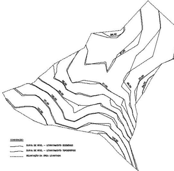
**Figura 8.** Figura representativa das curvas de nível e suas discrepâncias, obtidas a partir dos dois modelos digitais do terreno (MDT).
