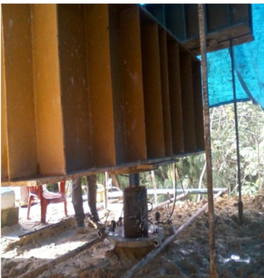
**Figura 7.** Vista lateral da prova de carga (Manaus, AM).
