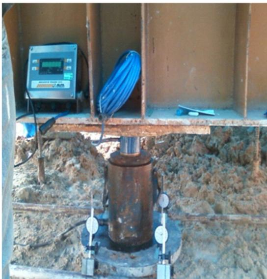
**Figura 6.** Vista frontal da prova de carga (Manaus, AM).
