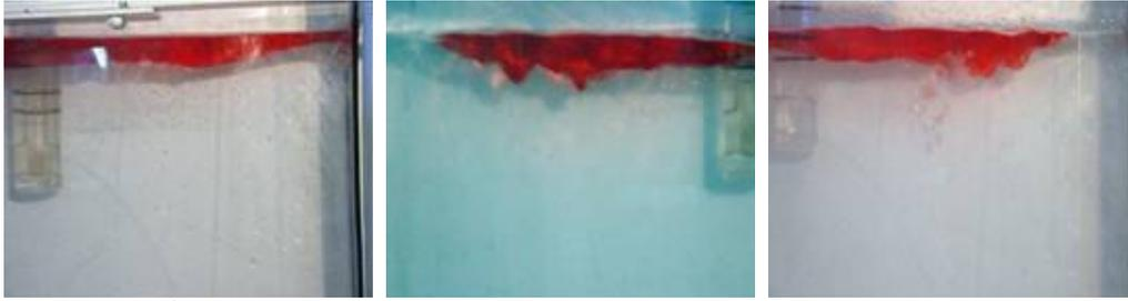
Figura 15. Deformación de la interfase con el aumento de la velocidad entre las capas. Izq. Interfase plana. Medio. Deformación de la interfase. Der. Deformación con rompimiento.
