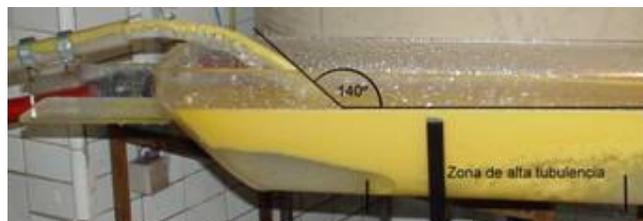
Figura 10. Zona de impacto del chorro proveniente de la piquera y zona de alta turbulencia.
