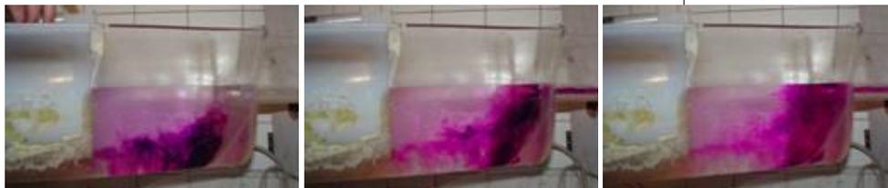
Figura 18. Flujo en la zona posterior al skimmer. Arriba: esquema del flujo. Abajo: Secuencia fotográfica mediante inyección de tinta a 2, 6 y 9 segundos.
