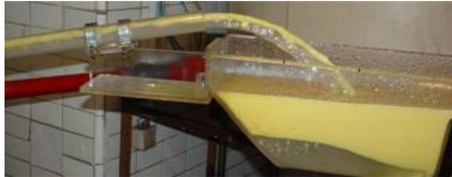
Figura 9. Flujo de la mezcla agua-aceite por el tubo de piquera.
