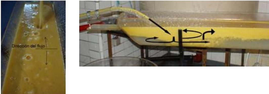
Figura 12. Zona de recirculación de escoria. Izq. Vista superior. Arriba. Vista lateral.
