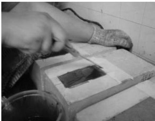
**Figura 8:** Aplicação do epóxi estruturante.
