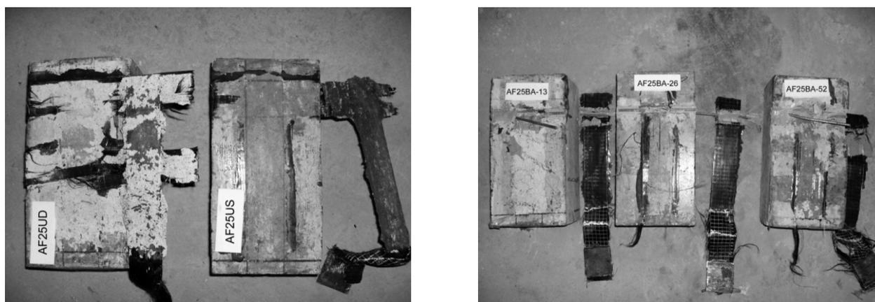
Figura 18: Aspecto dos prismas do Grupo II após os ensaios.
