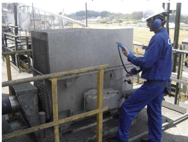
Figura 33: Momento da coleta de dados em um dos motores, com a utilização do sensor tipo "caneta" (Braskem/Triunfo, 2010).
