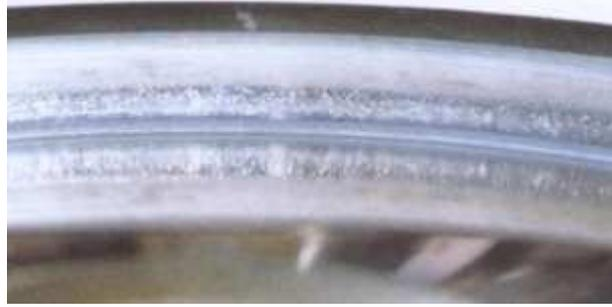
Figura 8: Anel interno de rolamento de rolos cônicos. (adaptado de NSK, 2001).
