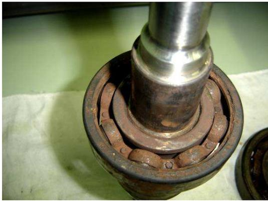
Figura 23: Rolamento com falha causada por falta de lubrificação (Braskem/Triunfo, 2007).
