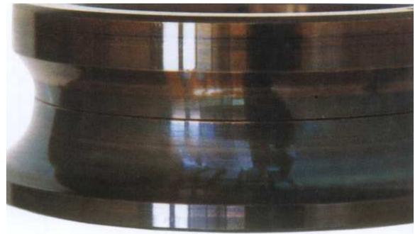
Figura 18: Anel interno do rolamento de quatro pontos contato angular (adaptado de NSK, 2001).
