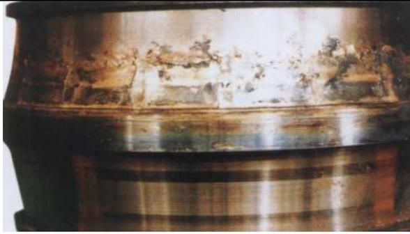
Figura 13: Anel interno de rolamento autocompensador de rolos (adaptado de NSK, 2001).
