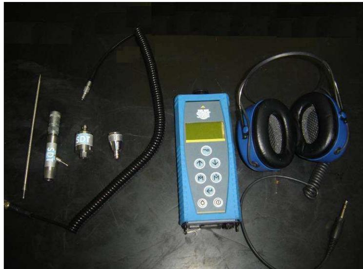
Figura 30: Ilustração dos acessórios aplicáveis para o monitoramento de condição dos mancais de rolamento. Da esquerda para a direita: (i) sensor tipo "caneta"; (ii) derivação para rosqueamento do acelerômetro e acoplamento da bomba de graxa; (iii) acelerômetro; (iv) sensor magnético; (v) cabo de extensão; (vi) aparelho coletor; (vii) fones de ouvido (Braskem/Triunfo, 2010).
