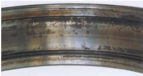
Figura 15: Anel externo de rolamento de rolos cilíndricos (adaptado de NSK, 2001).
