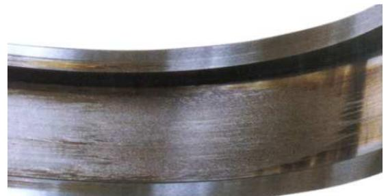
Figura 11: Anel externo do rolamento da Figura 10 (adaptado de NSK, 2001).
