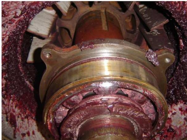
Figura 25: Rolamento de motor elétrico lado oposto ao acoplamento com graxa em demasia, causadora de superaquecimento (Braskem/Triunfo, 2010).
