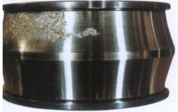
Figura 3: Anel interno de rolamento autocompensador de rolos (adaptado de NSK, 2001).
