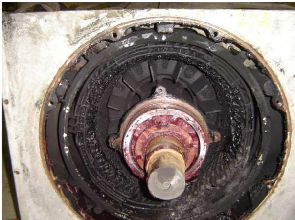
Figura 27: Motor elétrico que sofreu curto circuito entre fases na cabeceira de bobinas. A causa básica da falha foi contaminação com acúmulo de graxa na respectiva cabeceira, que bloqueou totalmente a possibilidade de refrigeração entre as bobinas (Braskem/Triunfo, 2010).
