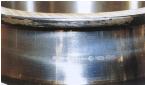
Figura 4: Anel interno de rolamento de contato angular (adaptado de NSK, 2001).
