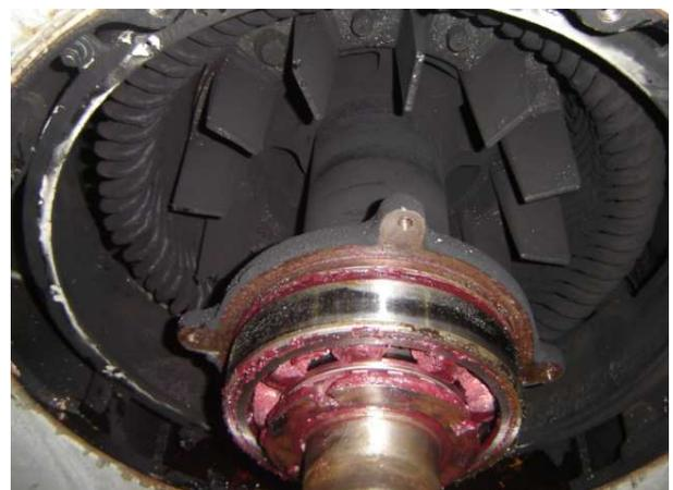
Figura 28: Motor elétrico que sofreu curto circuito entre fases na cabeceira de bobinas. A causa básica da falha foi contaminação com acúmulo de graxa na respectiva cabeceira, que bloqueou totalmente a possibilidade de refrigeração entre as bobinas (Braskem/Triunfo, 2010).
