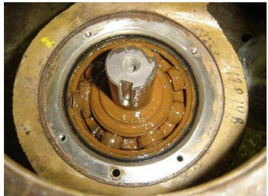
Figura 24: Rolamento com falha causada por contaminação do lubrificante com água (Braskem/Triunfo, 2008).
