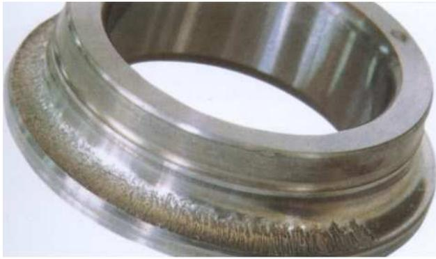
Figura 2: Anel interno de rolamento de contato angular (adaptado de NSK, 2001).
