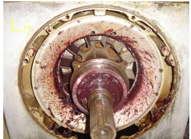
Figura 26: Rolamento de motor elétrico lado acoplado com graxa em demasia, causadora de superaquecimento (Braskem/Triunfo, 2010).
