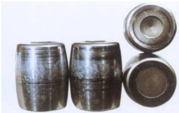
Figura 6: Rolamento autocompensador de rolos da Figura 3 (adaptado de NSK, 2001).
