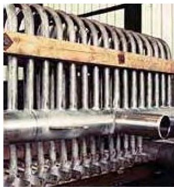
Figura 3: Detalhe da serpentina do forno de pirólise de etileno de onde foram retiradas as amostras.
